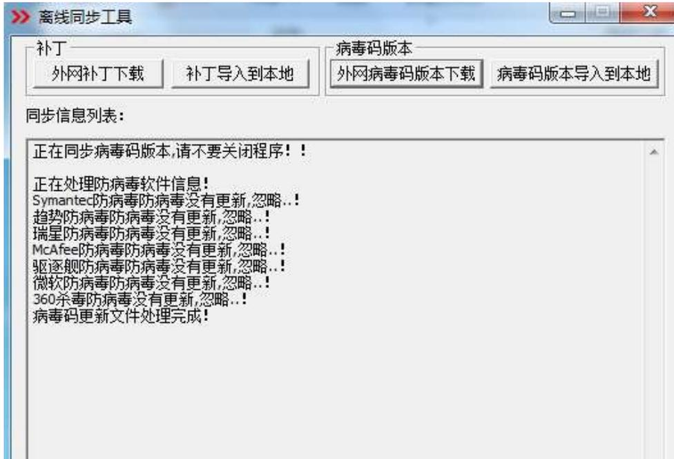
同步完成后，将离线同步工具目录拷贝到内网中心服务器任何目录下，并运行，点击“病毒码版本导入到本地”：
