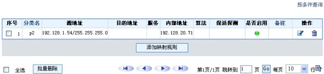
图 6-38 目的地址转换规则显示
