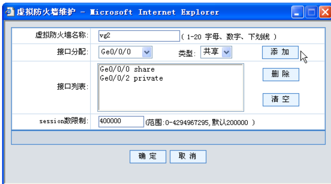
图 6-3 修改虚拟防火墙
