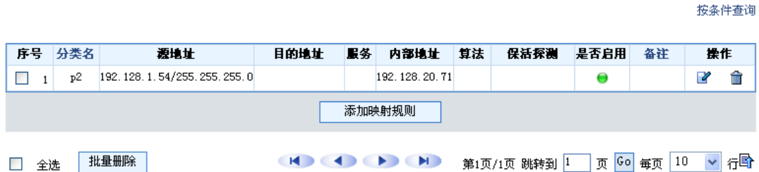
图 13-4 目的地址转换规则显示
